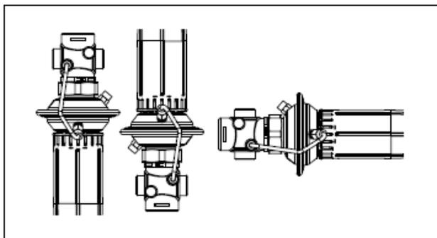
При температуре среды более 100 °С клапаны-регуляторы давления типа DPR следует устанавливать только на горизонтальном трубопроводе регулирующим блоком вниз.
