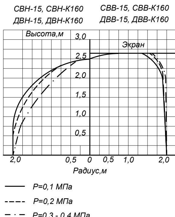
**Графики зависимости интенсивности орошения оросителей от давления на защищаемой площади 12 м<sup>2</sup>**
