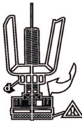
5. На выпускном и переливном отверстиях ванны установите выпуски с сифоном. Установите сифон присоединив выпуски на выпускном и переливном отверстиях, подключите сифон к канализации.
