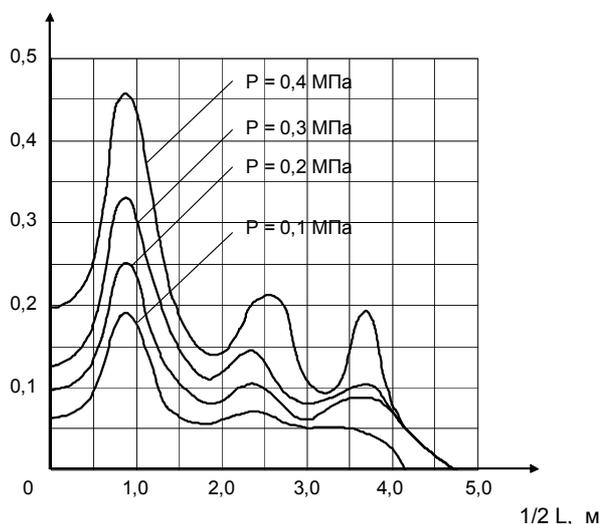
Рис. 2. Эпюры удельного расхода, Ду 8 мм.
