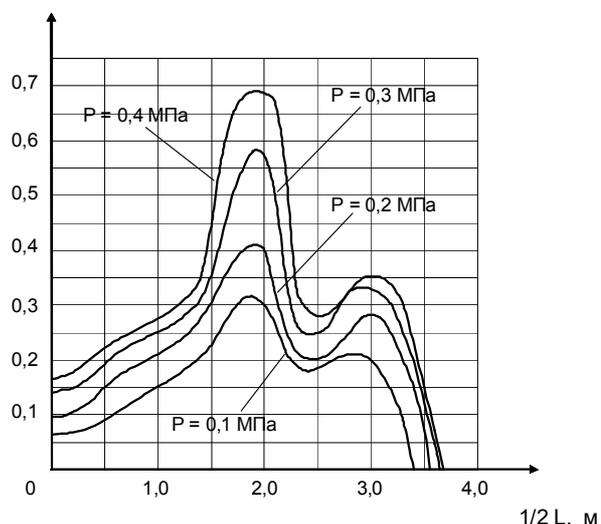
Рис. 3. Эпюры удельного расхода, Ду 12 мм.
