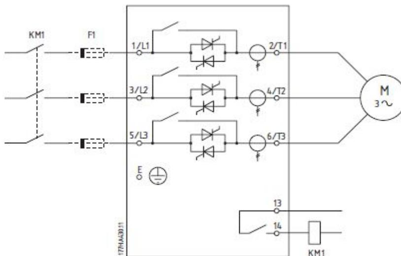
Рис. 2. Схема силовой части устройства плавного пуска.
