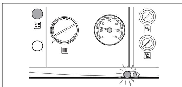
Котёл произведёт цикл запуска и продолжит работу до тех пока не достигнет установленной температуры.
