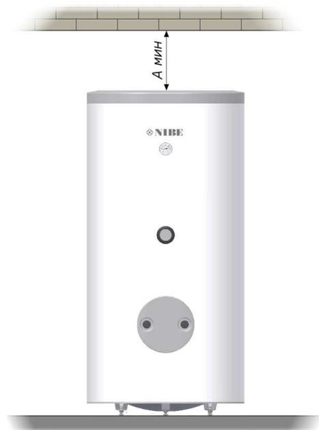
Рис. 3 Минимальное расстояние для замены защитного магниевого анода.
