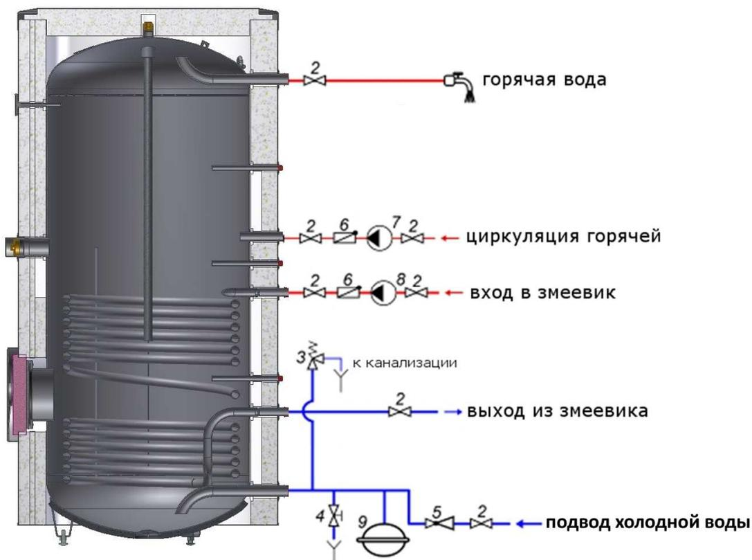
Рис. 6 Схема установки W-E 750/1000.81 R
