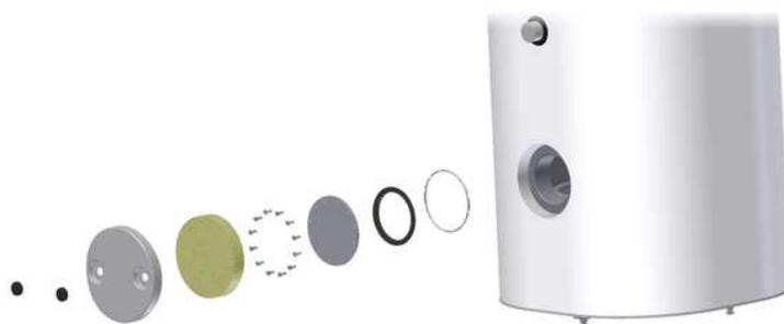
Рис. 11 Монтаж крышки смотрового отверстия (монтажная очередность)
