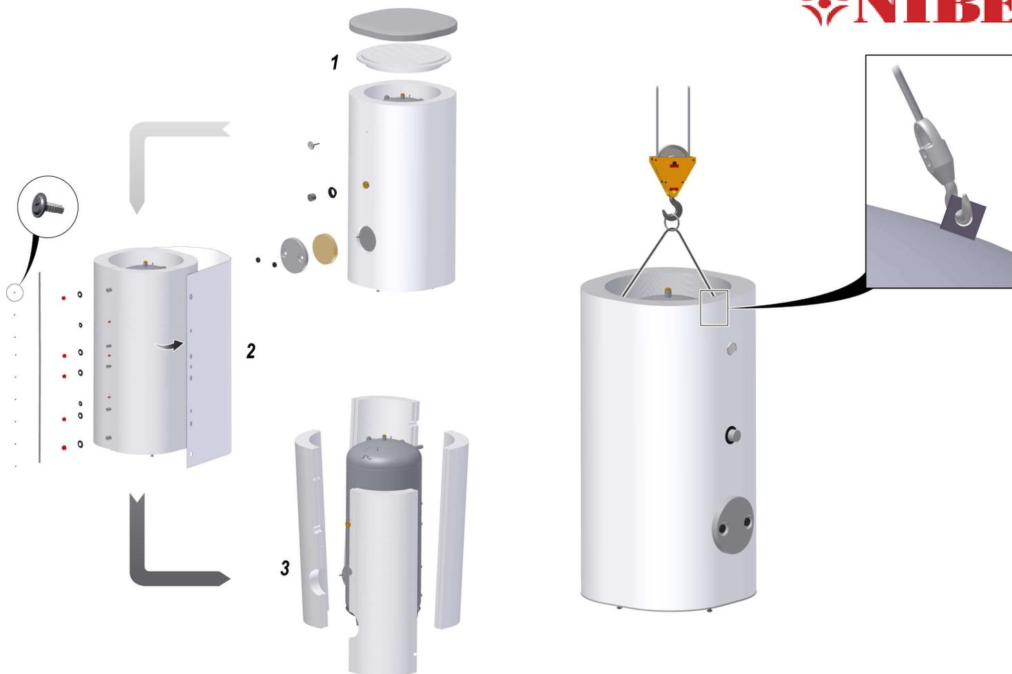
Рис. 5 Демонтаж корпуса
