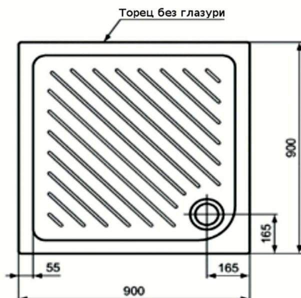
Диаметр сливного отверстия 90 мм.
