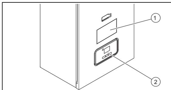
1 Краткое руководство по эксплуатации на магнитном креплении с обозначением типа и серийным номером
