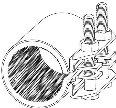
Толщина уплотнительного слоя составляет 3 мм для хомутов размером ½"–3" и 5 мм для размеров 3 ½"–6". Уплотнение изготовлено из NBR (бутадиен-нитрильный каучук) с рабочим диапазоном температур от -50°C до +110°C, время отвердения при +140°C – 42 мин. Уплотнение приклеено к корпусу. Рельеф поверхности уплотнения типа «вафля».
