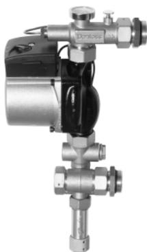
Компактные смесительные узлы Данфосс используют для регулирования расхода и температуры теплоносителя, подаваемого в систему гидравлического напольного отопления. Конструкция смесительного узла позволяет монтировать его как с левой, так и с правой стороны распределительного коллектора. Подключение подающего и обратного трубопроводов производится сбоку в нижней части смесительного узла.
