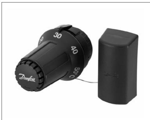
Термостатический элемент FTC применяют для регулирования температуры теплоносителя в системах напольного или радиаторного отопления. Термостатический элемент FTC в сочетании с двухходовым клапаном RA-N представляет собой регулятор температуры прямого действия.
