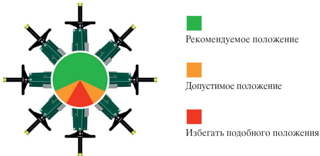
При установке задвижек размером >Ду200 под углом > 45°С на горизонтальном трубопроводе и задвижек размером >Ду200 на вертикальном либо наклонном трубопроводе, необходимо предусмотреть и установить дополнительное крепление привода задвижки во избежание деформации штока под весом привода. В противном случае это может привести к возникновению неисправностей в процессе эксплуатации задвижек.
