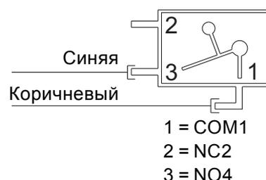
Рис. 1 Схема подключения
