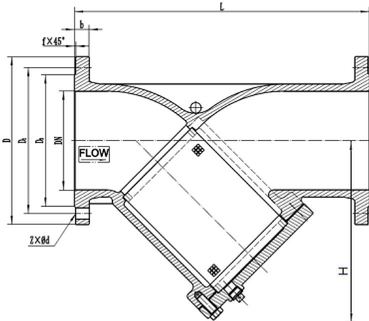
Габаритные размеры фильтров сетчатых типа ФСФ
