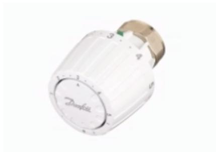
RTR 2945 – со встроенным температурным датчиком, защитой системы отопления от замерзания, диапазоном настройки температуры 5 – 26 °С, устройством для фиксирования и ограничения температурной настройки. Термоэлемент RTR2945 с соединительной гайкой следует использовать для клапанов Danfoss с присоединительной резьбой M30×1,5 серий RTD-N, RTD-G, РТД1, РТД2.
