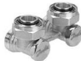
Клапаны запорные типов RLV-K, RLV-KD и RLV-KS предназначены для подключения к разводящим трубопроводам горизонтальных систем отопления отопительных приборов с нижним расположением присоединительных штуцеров с межосевым расстоянием 50 мм.
