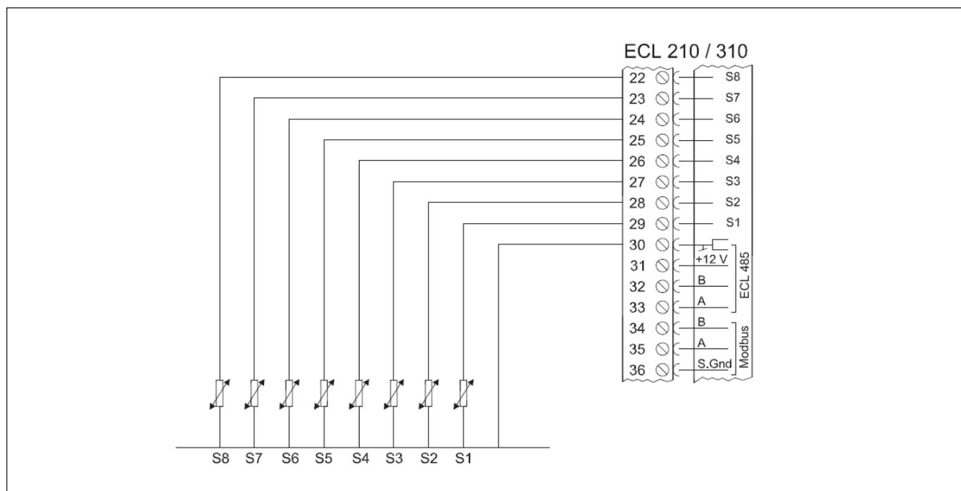
**Электрические соединения, датчики температуры Pt 1000 A375**
