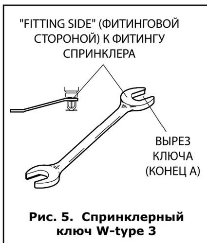
**Рис. 5. Спринклерный ключ W-type 3**
