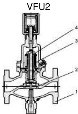
1. корпус клапана;
