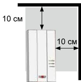
Для стационарного использования закрепите интерфейсный модуль WOLF Link pro на стене винтами через специальные проушины.
