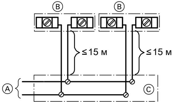
(A) К контроллеру или к концентратору шины KM-BUS (подключение см. на изображении на стр. 8)
