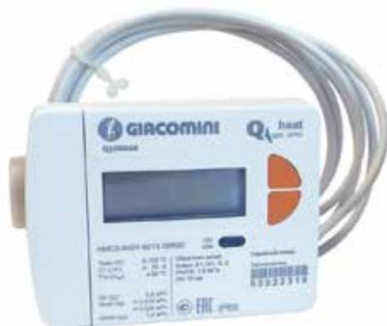
Приборы учёта тепловой энергии Giacomini GE552 применяются для установки в системы отопления, с использованием дополнительной монтажной арматуры. Устанавливаются на обратном трубопроводе в закрытых системах отопления, с температурой теплоносителя не превышающей +90°C.
