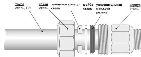
Рис. 1 Конструкция и спецификация материалов обжимной муфты.
