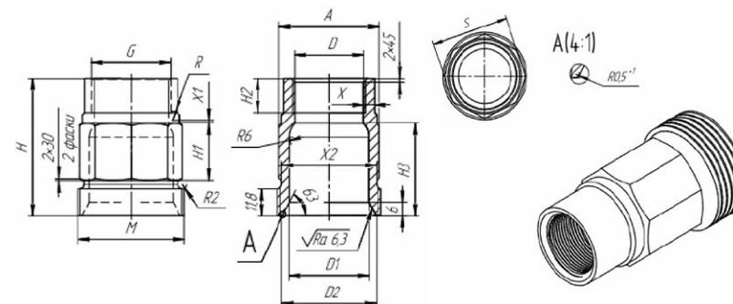
Рис. 2 Габаритные и присоединительные размеры корпуса обжимной муфты.
