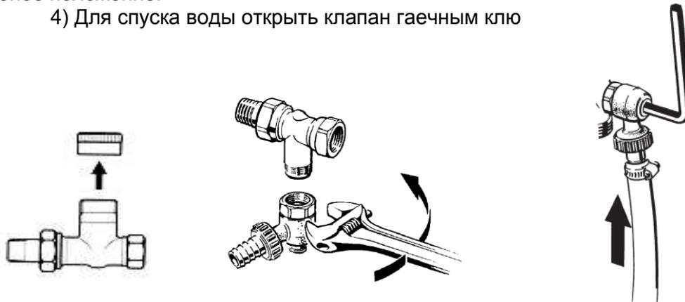
Рис. 3. Монтаж спускного крана.
