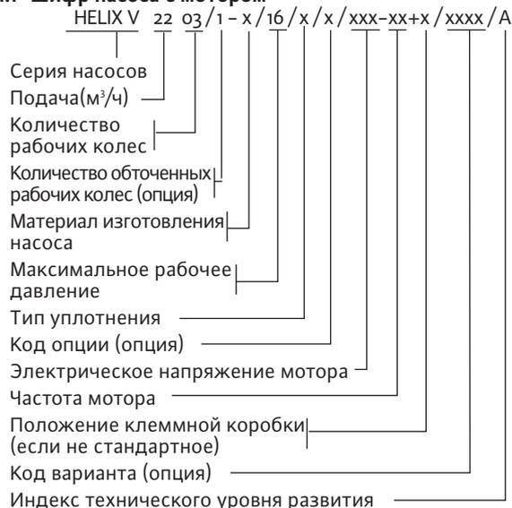
**5.1.2 Шифр насоса (без мотора)**
