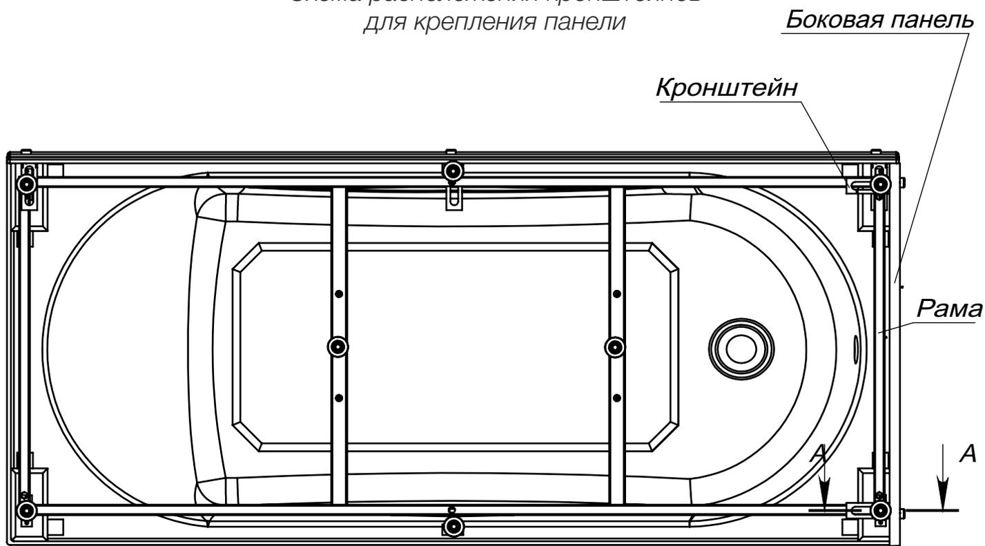
Панель устанавливать как показано в сечении А-А. Держатели панели крепить гайками М10 к опорной конструкции. Отверстия под саморезы в панели и в держателях сверлить совместно. При сверлении соблюдать осторожность - не допускать ударов дрели об панель.
