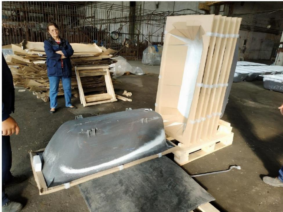
Для удобства распаковки, высота упора должна составлять 100÷200 мм. Упором может служить деревянная рамка с резиновым покрытием или деревянный поддон, как указано в разделе «Необходимый инструмент и приспособления».
