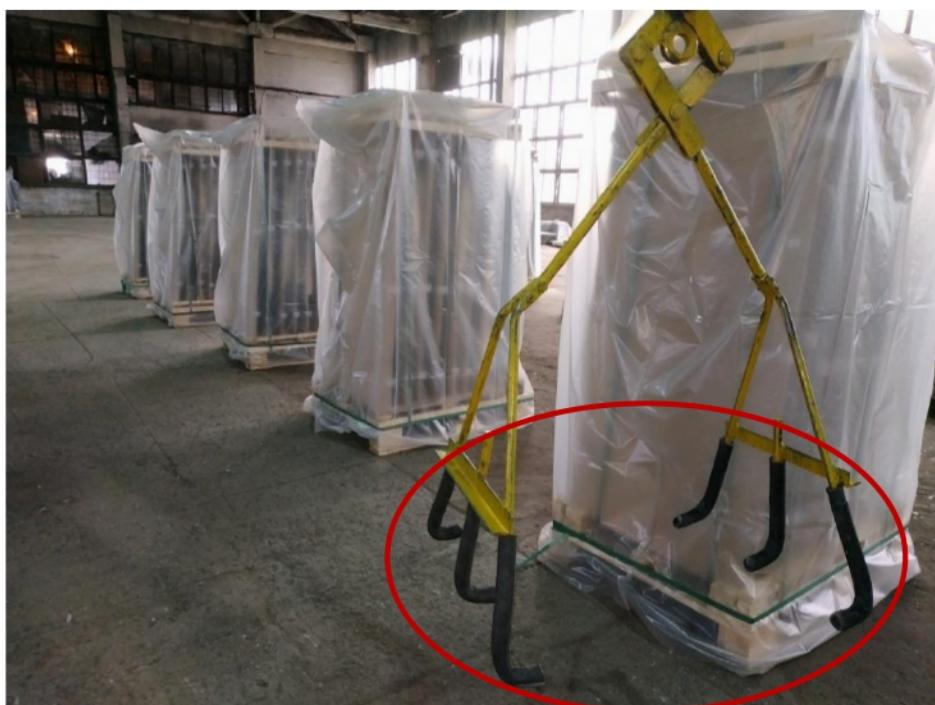
При работе гидравлической тележкой (рохлей), автопогрузчиком, прочими грузоподъемными механизмами, инструментом и приспособлениями, не допускать их соударения с ванной. Это может привести к образованию сколов, сдиров и трещин на эмалированной поверхности.
