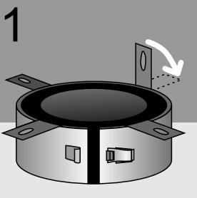
Отогнуть крепежные проушины в плоскости основания муфты;
