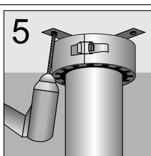
Закрепить муфту с помощью саморезов или анкерных болтов. **ВНИМАНИЕ! ДЛЯ КРЕПЛЕНИЯ МУФТ ИСПОЛЬЗОВАТЬ ТОЛЬКО МЕТАЛЛИЧЕСКИЕ ДЮБЕЛЯ;**
