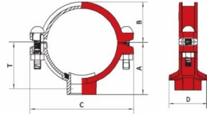
Рис.1. Габаритные размеры отвода (седелка) под резьбу «LEDE».
