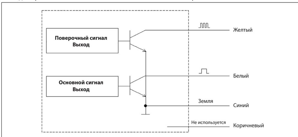
Расходомер типа SONO 1500 CT с гальванически-развязанным импульсным выходом:
