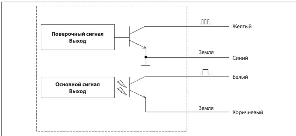
Схема соединения расходомера типа SONO 1500 CT с вычислителем СПТ 943.1:
