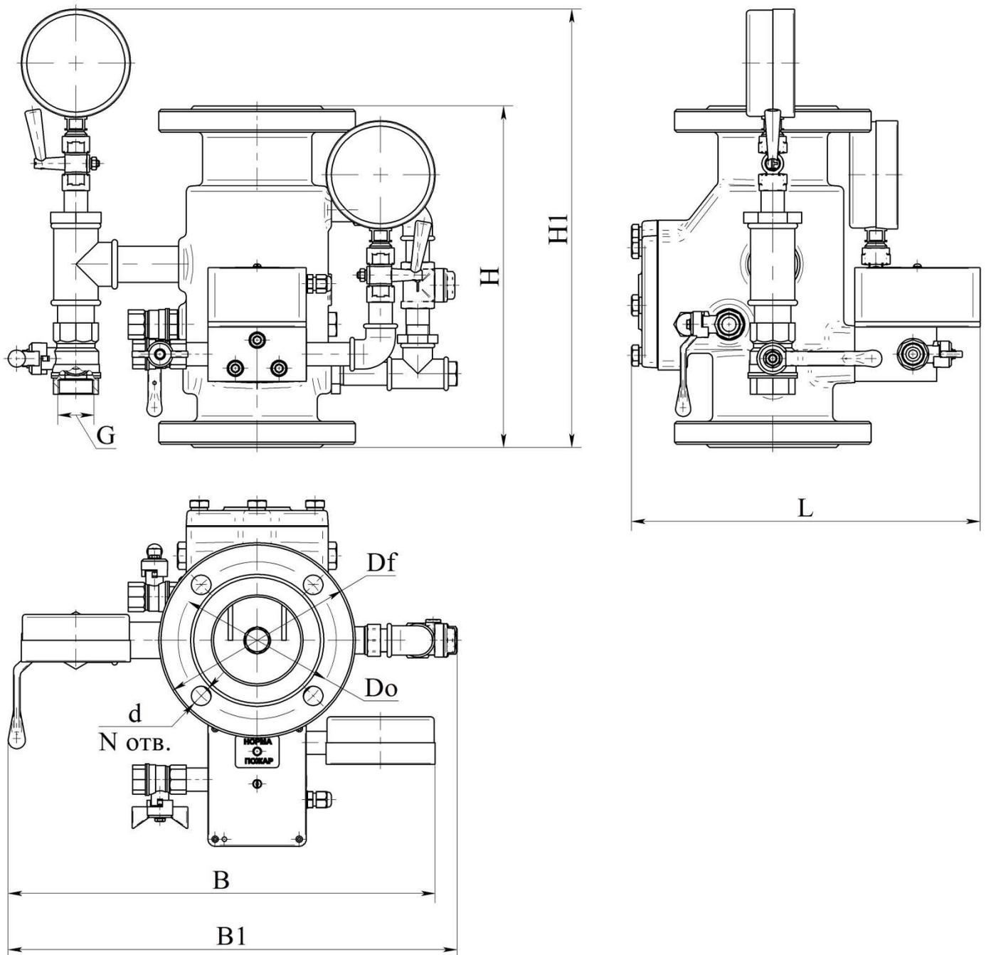
Таблица А.1 - Габаритные и присоединительные размеры УУ с устройством задержки
