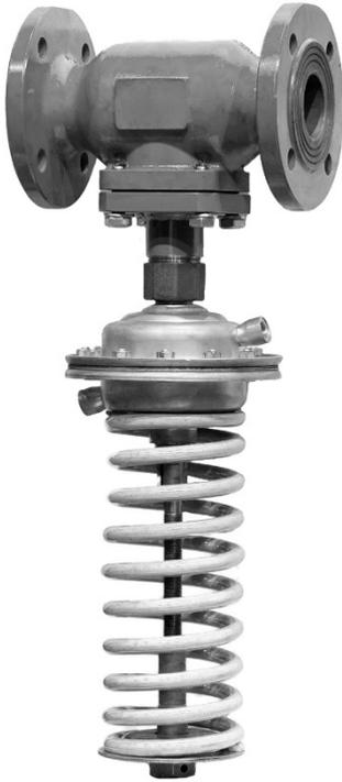
Регулятор прямого действия ДРК 22-М/СРК22 предназначен для автоматического поддержания стабильного перепада давлений в регулируемом контуре в системах центрального теплоснабжения. Регулятор ДРК 22-М/СРК22 обеспечивает требуемые условия для корректной работы регулирующих клапанов при изменении располагаемого напора и/или расхода теплоносителя, снижая риск возникновения шумов.
