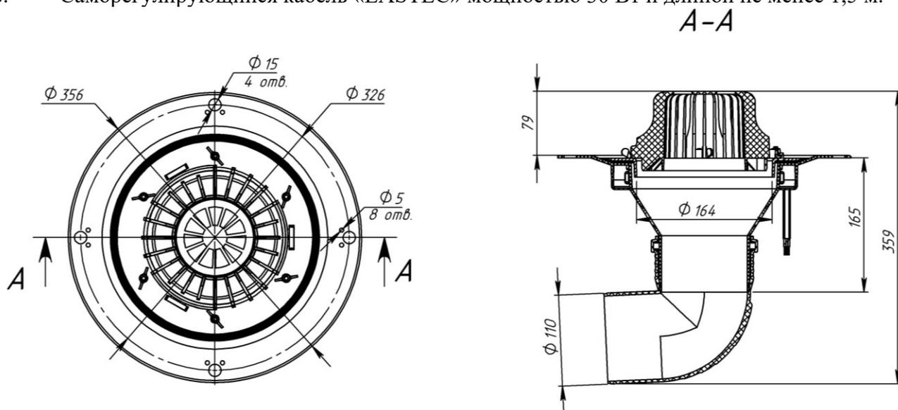
Рис. 1. Схема воронки VMCO
