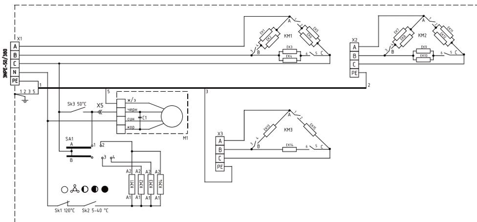
Ручкой терморегулятора 2 устанавливается необходимая температура нагрева воздуха в помещении в диапазоне от +5 до +40°C. Терморегулятор управляет включенной мощностью.
