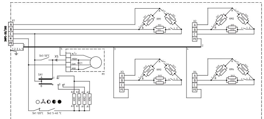
Рис. 4. Электрическая схема КЭВ-50Т20Е
