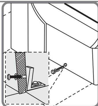
**RUS** Закрепить унитаз к полу при помощи специального комплекта крепежа (боковое крепление).
