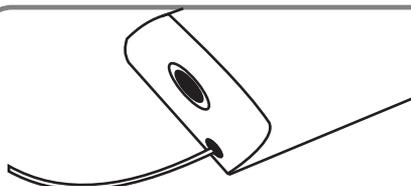
**RUS** К наполнительному клапану бачка присоединить шланг подвода воды.
