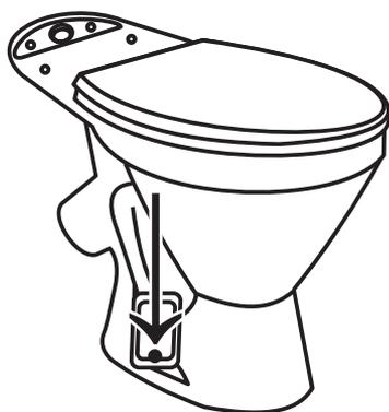
**RUS** Произвести разметку крепления унитаза к полу. Закрепить унитаз к полу при помощи специального комплекта крепежа. Внимание! Запрещается устанавливать изделие на свежееуложенный пол.
