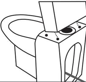
**RUS** Прикрепить при помощи крепежных болтов бачок к унитазу.
