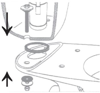
**RUS** Надеть уплотнительную прокладку на корпус сливной арматуры. Установить бачок с арматурой на полочку унитаза и прикрепить его с помощью крепежных болтов.
