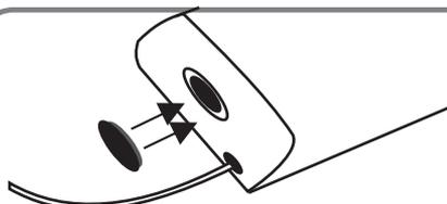
**RUS** Надеть уплотнительную прокладку на корпус спускной арматуры.
