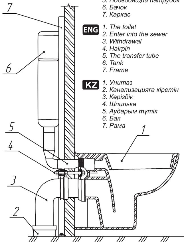
**RUS** Произвести предварительную разметку места установки унитаза. Раму можно смонтировать на любой высоте от пола. Рекомендуется отрегулировать каркас таким образом, чтобы расстояние от сливного бачка до пола было примерно 1 метр. Расстояние от верхней поверхности чаши до пола определяют индивидуально (ориентировочно для взрослого человека оно составляет 40 см.)
