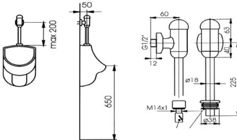
Для использования крана необходимо нажать на сферическую кнопку. Произойдет открытие клапана смыва, затем клапан автоматически закроется.
