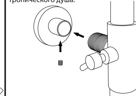
**11** Включите систему водоснабжения. Проверьте герметичность соединений при закрытом положении рукоятки смесителя.
