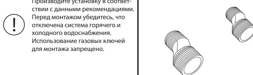
**3** Прикрутите корпус смесителя к эксцентрикам, используя инструменты, щадящие хромированную поверхность.
