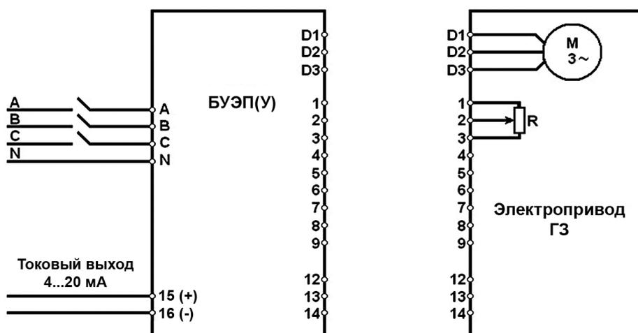
Рис. 5 Блок-схема подключения БУЭП(У) к электроприводе
