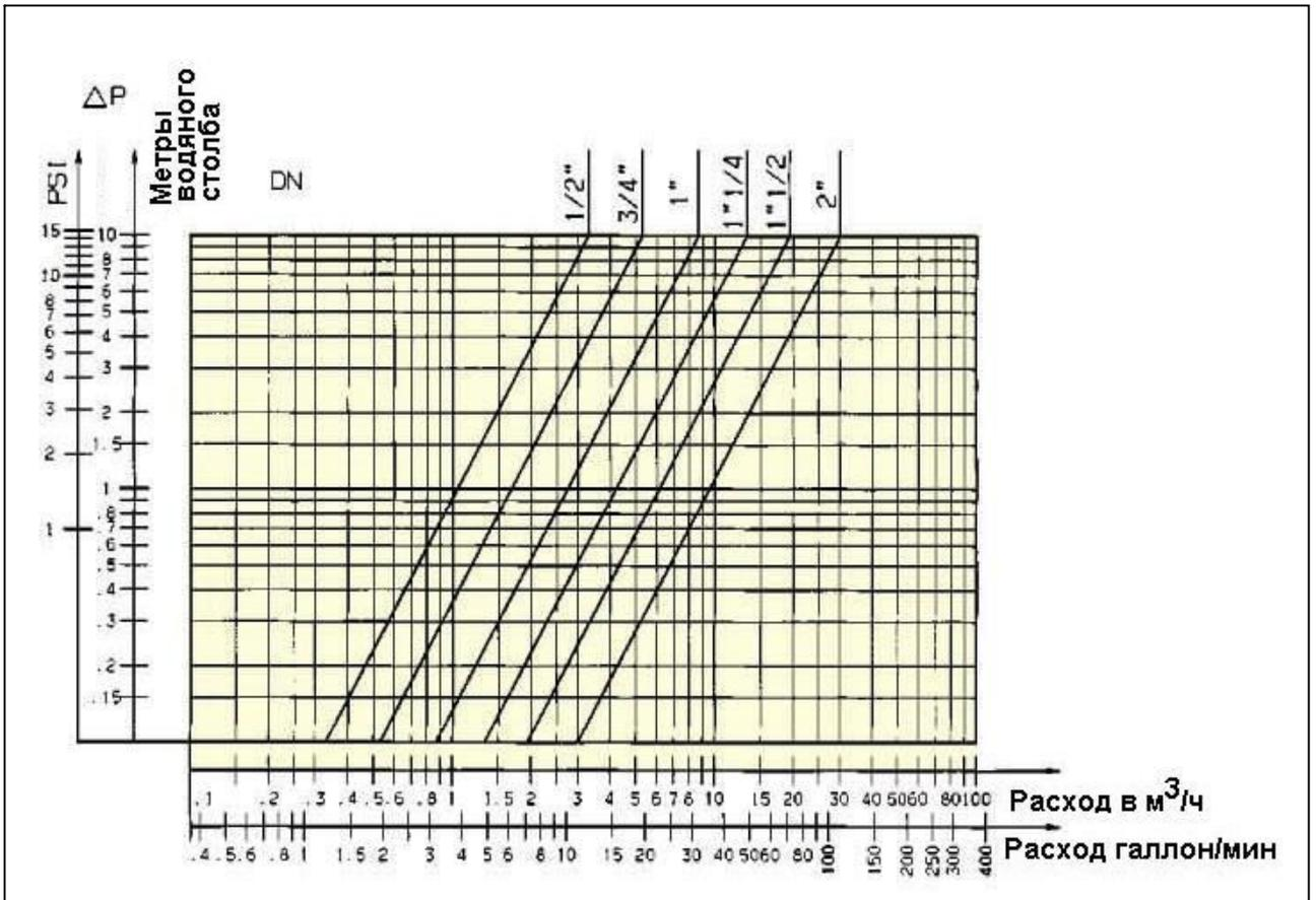
Рис. 35 Диаграмма зависимости потерь давления от расхода рабочей среды клапана тип 223.
