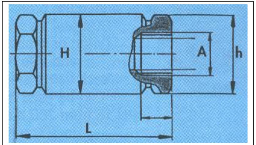
Рис. 36 Габаритные и присоединительные размеры клапанов тип 223, 223Х.
