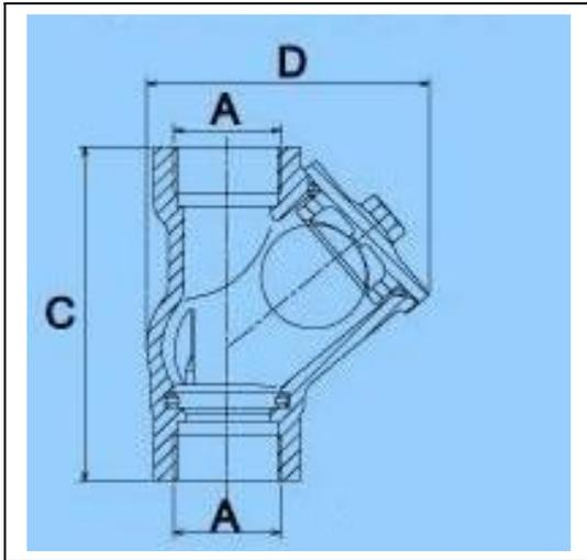
Рис. 31 Габаритные и присоединительные размеры клапанов тип 508, 508F.
