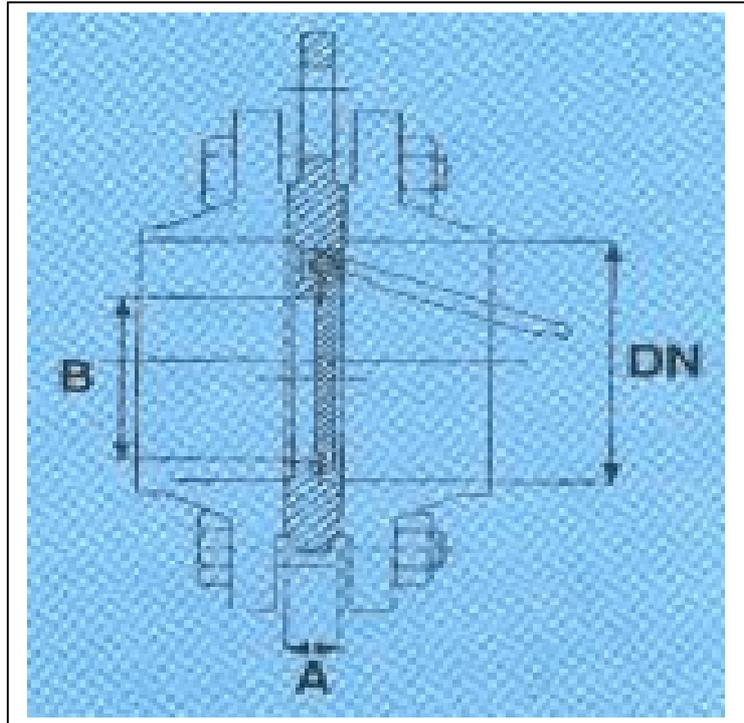
**Рис. 10** Габаритные и присоединительные размеры клапанов тип 605N/604N, 605V/604V .
