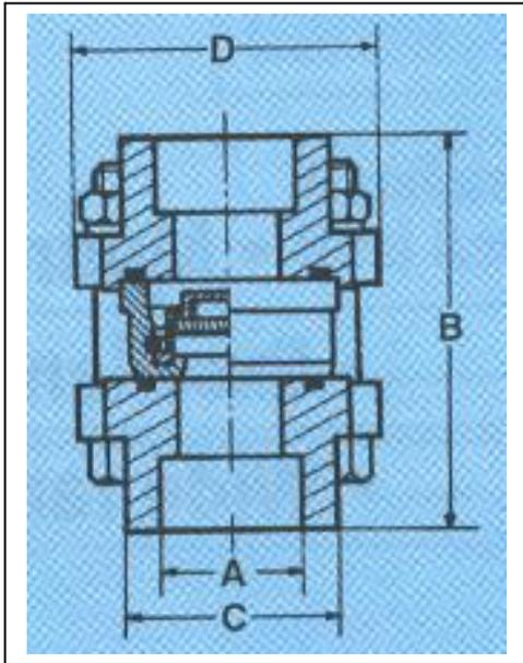
Рис. 25 Габаритные и присоединительные размеры клапана тип 812XS.
