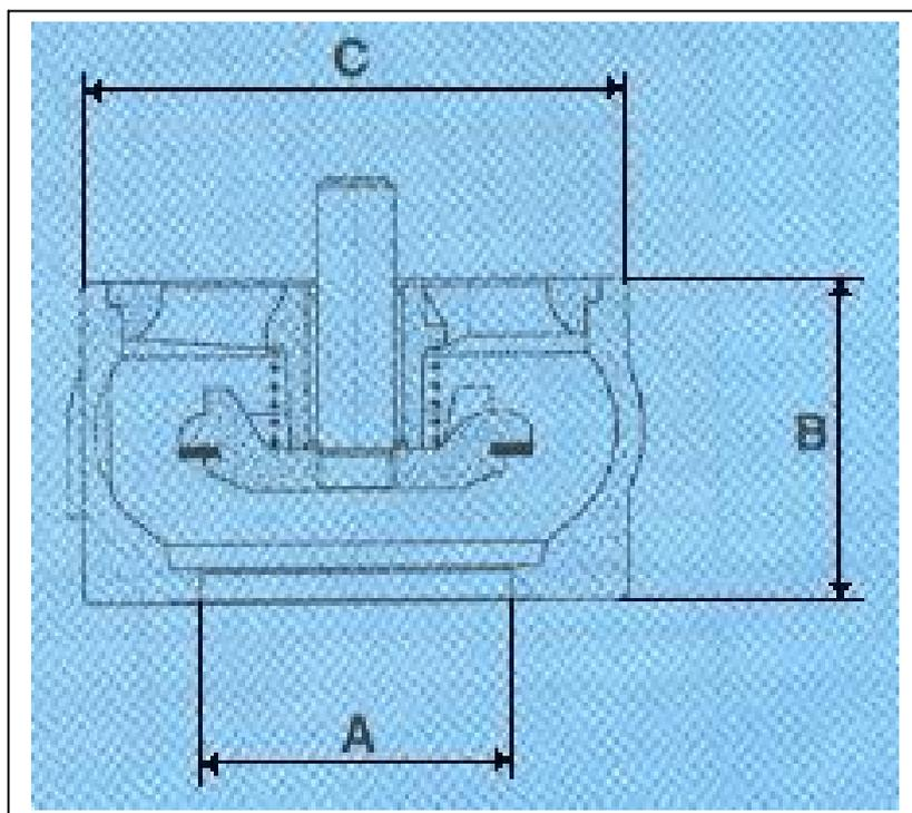
Рис. 27 Габаритные и присоединительные размеры клапана тип 882.
