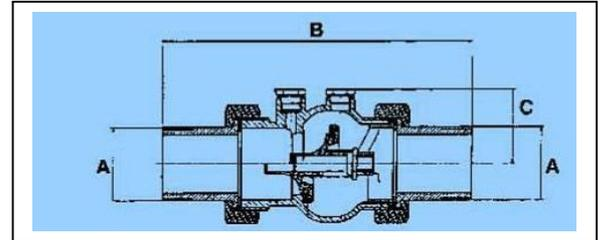
Рис. 6 Габаритные и присоединительные размеры клапана тип 223D.
