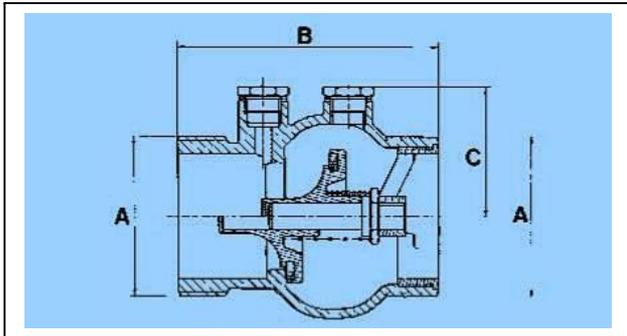
Рис. 5 Габаритные и присоединительные размеры клапана тип 223.
