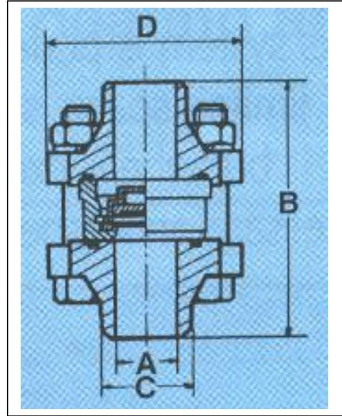
Рис. 26 Габаритные и присоединительные размеры клапана тип 812XB.
