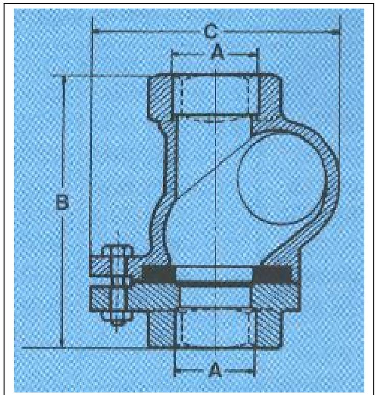
Рис. 29 Габаритные и присоединительные размеры клапана тип 50.
