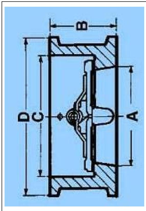
Рис. 14 Габаритные и присоединительные размеры клапанов тип 805, 815, 825, 895, 895V.
