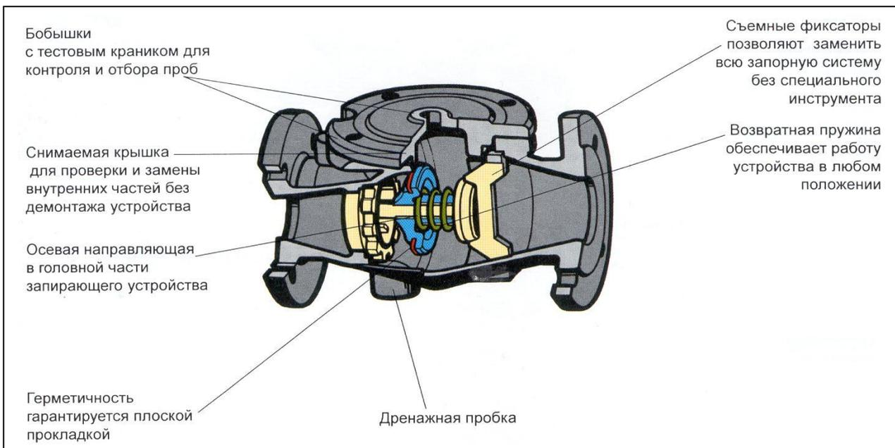
Номенклатура и технические характеристики клапанов обратных тип 223, 223D.
