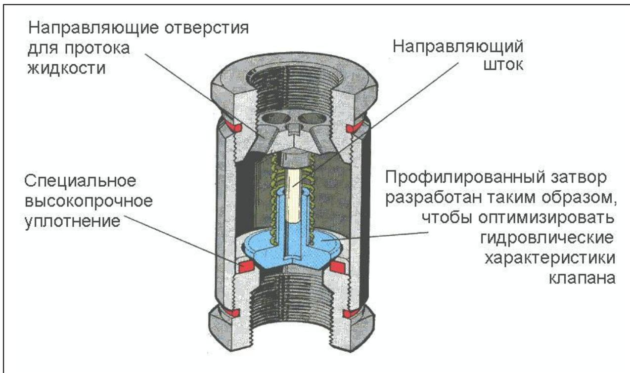
Номенклатура и технические характеристики клапанов обратный тип 233.
