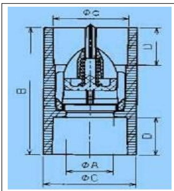
Рис. 8 Габаритные и присоединительные размеры клапана тип 601P.
