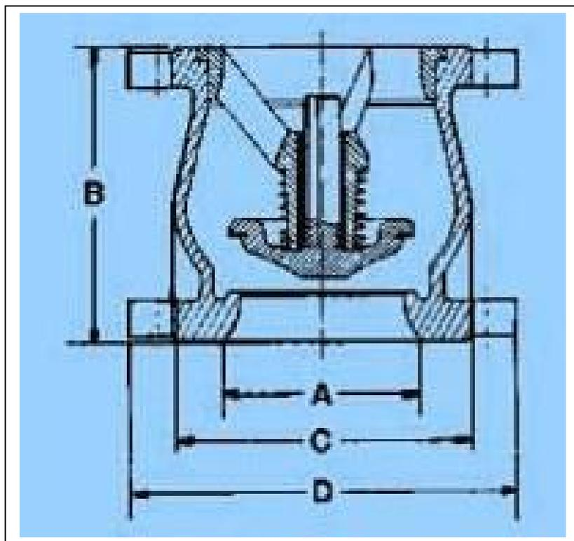
Рис. 3 Габаритные и присоединительные размеры клапана тип 412, 412S.
