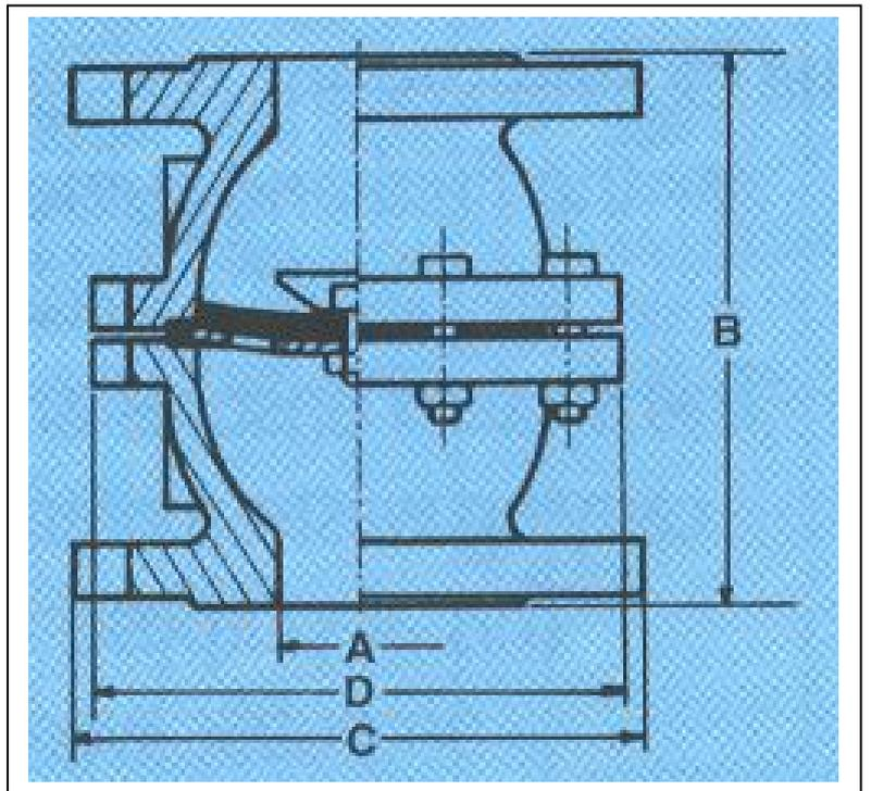
Рис. 18 Габаритные и присоединительные размеры клапана тип 417.
