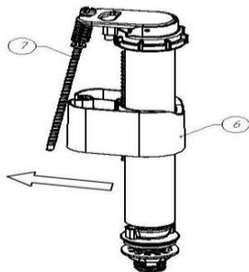
отсоединить тягу от поплавка
