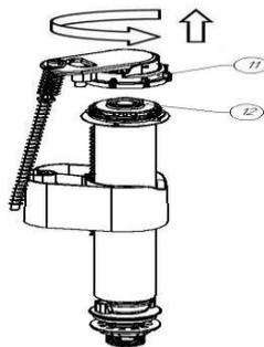
повернуть крышку против часовой стрелки и
