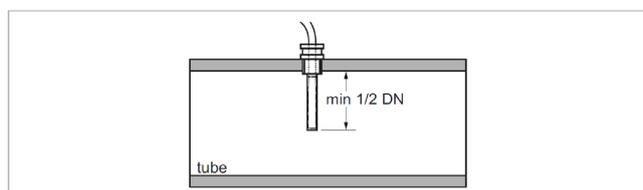
При установке необходимо обеспечить надлежащую механическую защиту зонда и кабеля зонда. В случае очень горячих контактных частей необходимо изолировать кабель. Благодаря оптимизации теплоизоляции точки измерения, влияние температуры окружающей среды на работу привода исключается.
