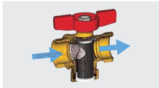
Когда кран открыт, теплоноситель проходит через фильтр, затем он замедляется, чтобы обеспечить отделение твердых частиц. Примеси фильтруются при прохождении через металлическую сетку и попадают на дно колпачка. Специальная структура корпуса крана позволяет эксплуатировать всю поверхность фильтра, увеличивая время работы краны без очистки фильтра.
