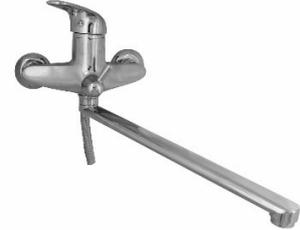
Смеситель общий для ванны и умывальника однорукояточный, настенный, с душевой сеткой на гибком шланге, с изливом с развальцованным носиком (может быть укомплектован изливом с аэратором). Смеситель общий для ванны и умывальника предназначен для смешивания холодной и горячей воды, устанавливается на стене ванной комнаты в жилых помещениях зданий.
