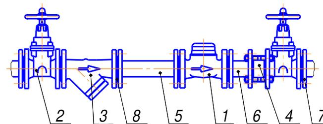
1. Счетчик воды, 2. Задвижка, 3. Фильтр магнитный, 4. Клапан обратный, 5. Патрубок
