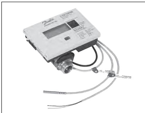
Теплосчетчик Sonometer 500 предназначен для измерения, обработки и представления текущей и архивной информации о количестве потребленной тепловой энергии, температуре, расходе теплоносителя и сопутствующих данных в системах водяного отопления индивидуальных потребителей (поквартирный учет) при температуре теплоносителя от 15 до 90 °С. Теплосчетчик может устанавливаться на подающем или обратном трубопроводе.
