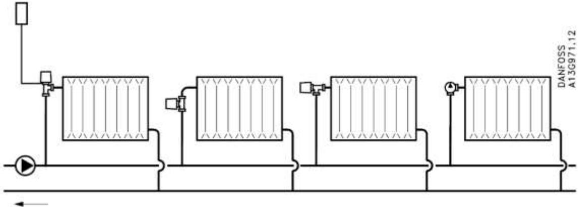
Клапаны регулирующие типов RA-U, RA-UN, RA-UR, RA-URX предназначены для применения в двухтрубной насосной системе водяного отопления.
