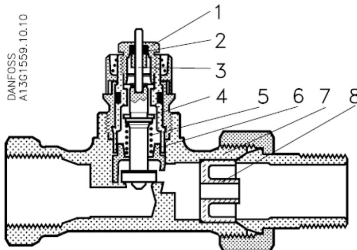
**Рис. 4.** Клапаны типов RA-U, RA-UN, RA-UR, RA-URX.
