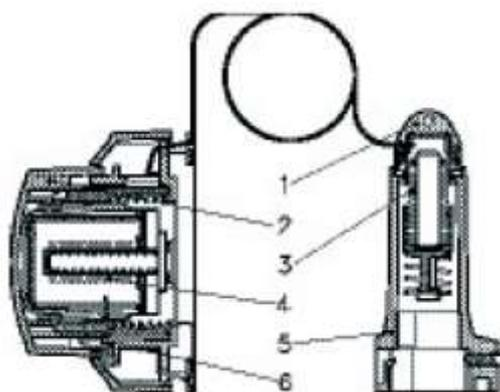
**Рис. 2.** Элементы термостатические типов RA и RAX с дистанционным управлением.
