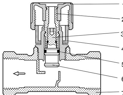
Устройство клапана USV-I
