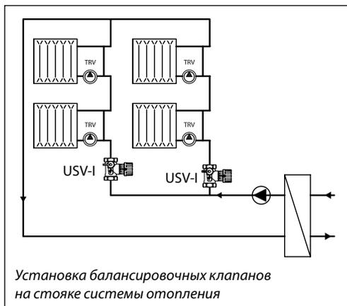
Установка балансировочных клапанов на стояке системы отопления
