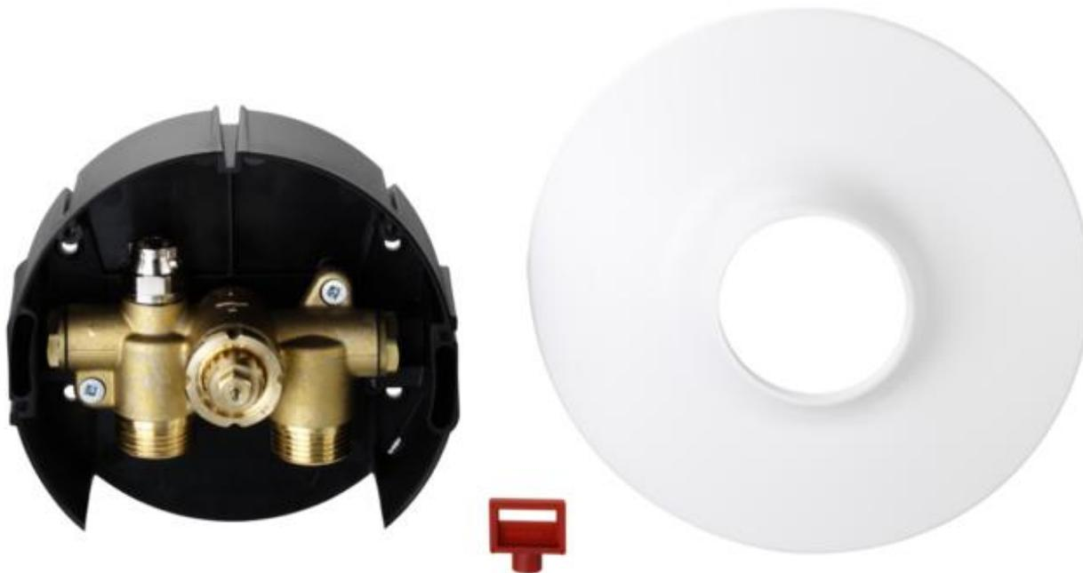
Клапан-регулятор температуры типа FHV-R совместно с элементом термостатическим типа FJVR служат для ограничения температуры в контуре теплого пола. Клапан предназначен для монтажа в стене и закрывается декоративной крышкой. Оснащен ручным воздухоотводчиком и может подключаться к трубопроводам с помощью фитингов.
