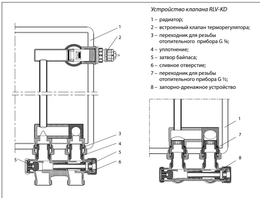
Устройство клапана RLV-KD
